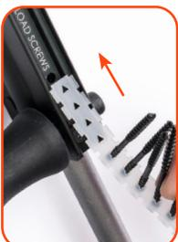
Engagez la bande de vis dans le canal de bande de vis.
