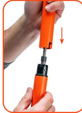
Alignez les encoches du corps supérieur de l'outil avec les goupilles de verrouillage et poussez vers le bas tout en tournant pour verrouiller en place.
