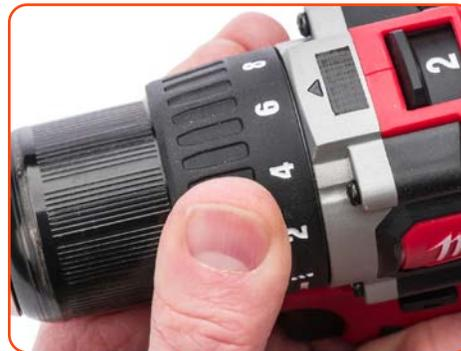
Si votre perceuse est munie d'un mode perceuse et embrayage, réglez-la sur le mode embrayage. Réglez votre perceuse à 30 % du couple maximum.
