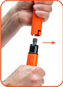
Séparez l'outil en tournant le corps supérieur de l'outil dans le sens antihoraire et en faisant glisser les goupilles de verrouillage hors des encoches.
