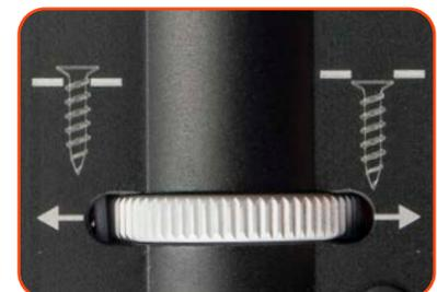
Avant d'entreprendre de fixer le dessus de la terrasse, vissez quelques vis dans un morceau de bois désuet et ajustez le cadran de profondeur en conséquence. Pour les vis de façade, vous pouvez les affleurer ou les fraiser.
