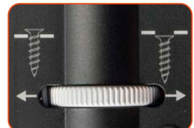
Avant d'entreprendre de fixer le dessus de la terrasse, vissez quelques vis dans un morceau de bois désuet et ajustez le cadran de profondeur en conséquence. Pour les vis Edge, enfoncez-les de 1/8 à 1/4 po sous la surface de la planche de terrasse.
