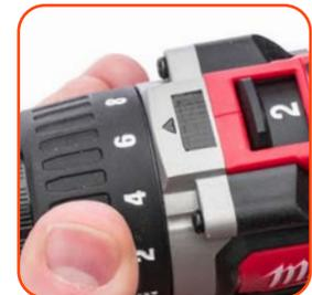
Si votre perceuse est munie d'un mode perceuse et embrayage, réglez-la sur le mode embrayage. Réglez votre perceuse à 30 % du couple maximum.
